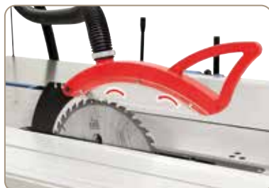
Savklingebeskyttelse med integreret udsugningsstuds er fastgjort på spaltekniven. Er standard udstyret med forridser.
