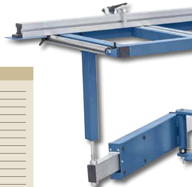
Parallellanslag med stabil rundstangsføring (40 mm) kan anvendes til snitbredder op til 1220 mm.
