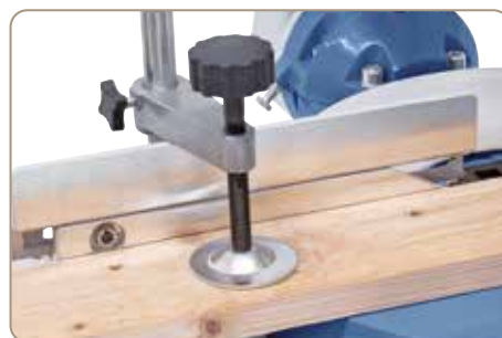
Sikker fastgørelse af emnet ved hjælp af nedholder, der kan justeres i højden.
