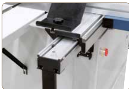
Det store formatbord kører let og uden slid på en hærdet prismeføring.
