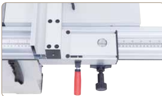
Luppen, der er integreret i længdeanslaget, gør det lettere at læse mm-skalaen og muliggør således en nøjagtig indstilling af den ønskede snitbredde.
