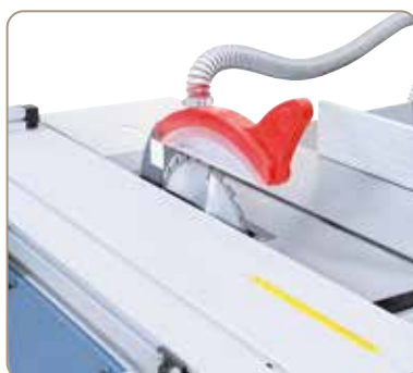
Savklingebeskyttelse med integreret udsugningsstuds er fastgjort på spaltekniven.
