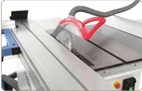
Savklingen kan drejes til præcise vinkelsnit på 90° til 45°.
