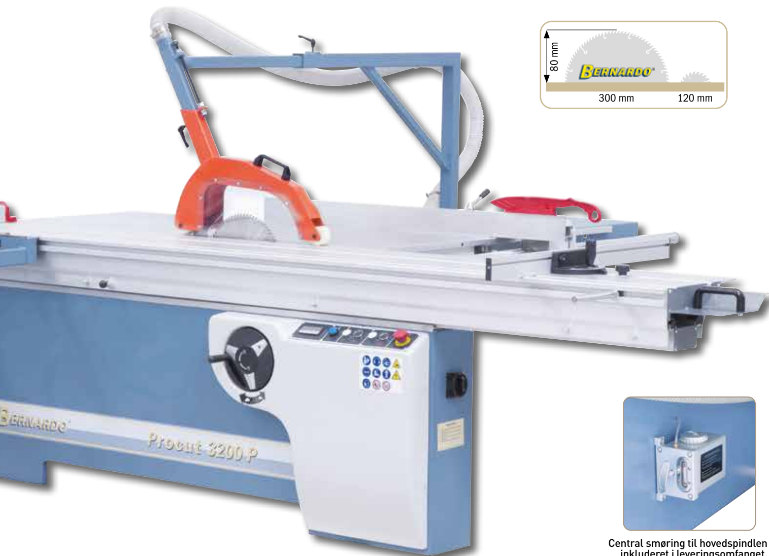
Præcis indstilling af den ønskede skærevinkel vha. et digitalt display.
