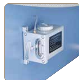
Central smøring til hovedspindlen inkluderet i leveringsomfanget.
