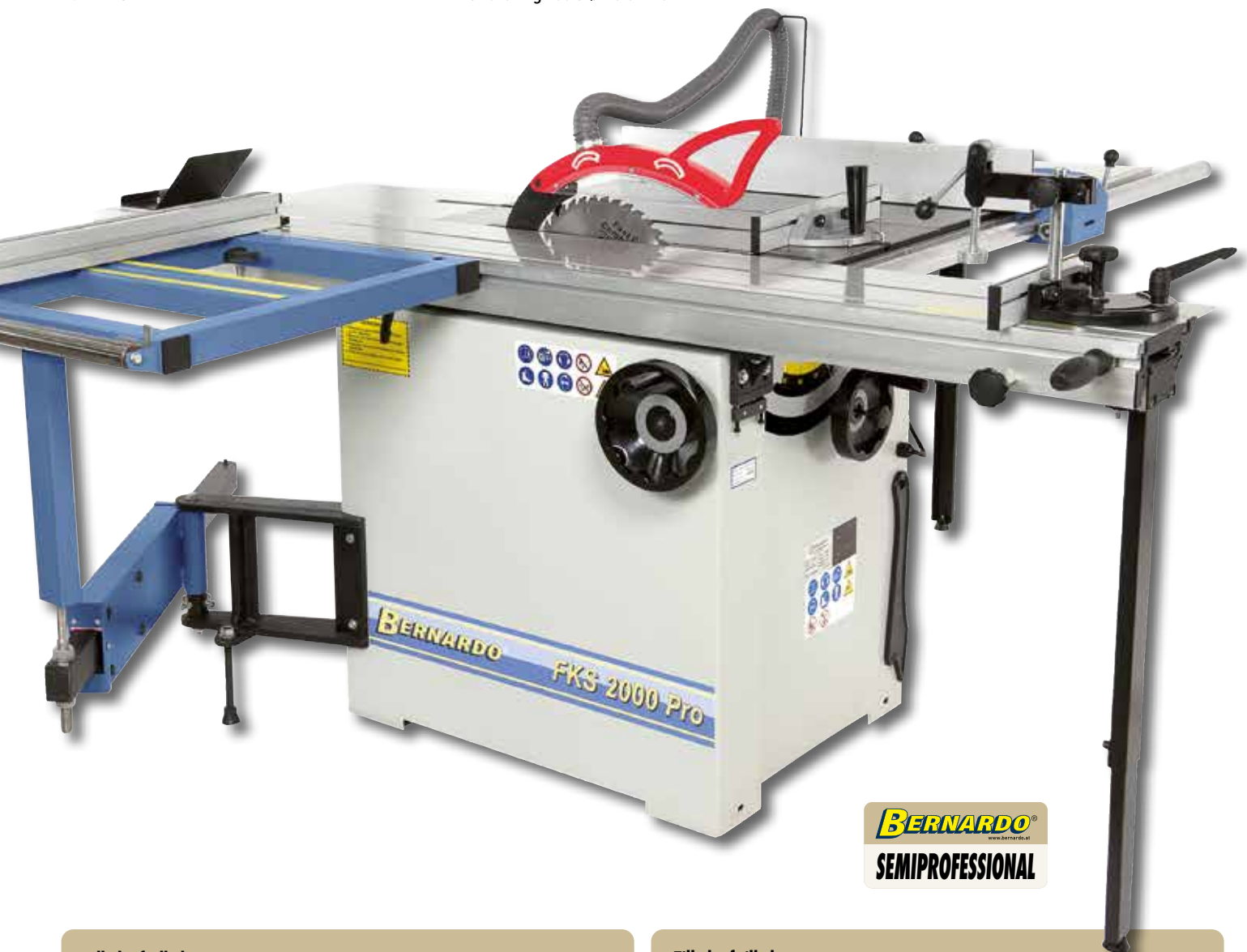
Stort arbejdsbord og standard bordforlængelse til skærebredder på op til 1200 mm.
