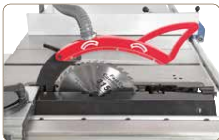
Som standard med forridser til revnefri bearbejdning af pladematerialer.
