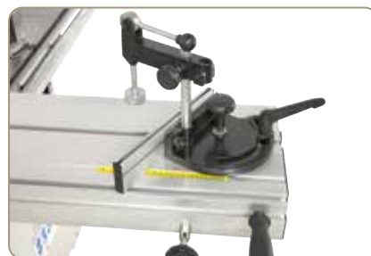
En skala, der er integreret i bordet, giver mulighed for præcis indstilling af geringanslaget.
