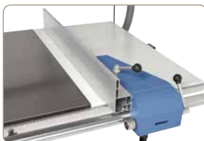
Nedklappeligt parallelanslag med mikrometrisk finindstilling (fordel ved store plader)
