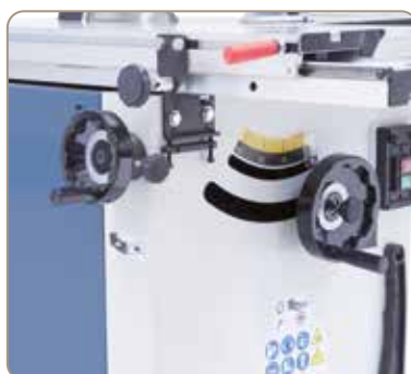
Højdejusteringen eller drejningen af savklingen udføres ved hjælp af ergonomisk fastgjorte håndhjul.
