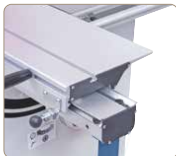
Den vridningsfri glidebord garanterer præcis arbejde takket være den jævne styring.
