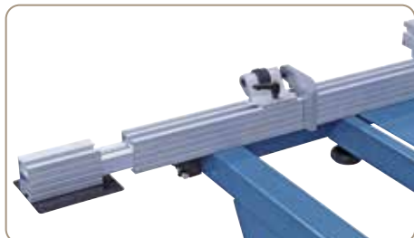
Udtrækkeligt teleskopanslag op til 1900 mm med finindstillig anslagsklap.
