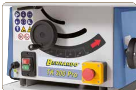
Start/stop-afbryder iht. IP 54 med underspændingsudløser og separat nødstopafbryder.
