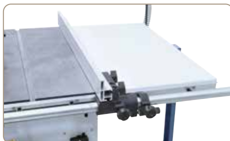
Præcis styring af aluminiumparallelanslaget ved hjælp af en 30 mm rundstang.
