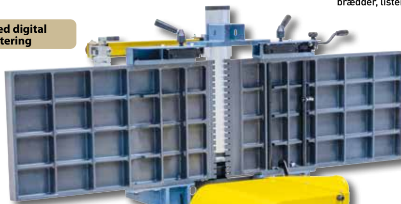
Dobbelt opklapning af afretterborde til maksimal betjeningskomfort.
