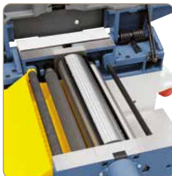
Reduceret støjbelastning på grund af bordlæber i begge sider.
