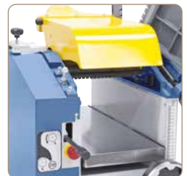
Stabilt tykkelsesbord af gråt støbegods med centralføring i midten og klemning, til høvling af emner op til en højde på 190 mm
