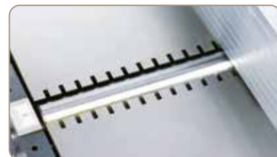
Støjreduktion pga. integrerede bordlæber.
