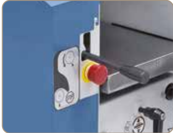
Fremføring kan slås fra til afretning.
