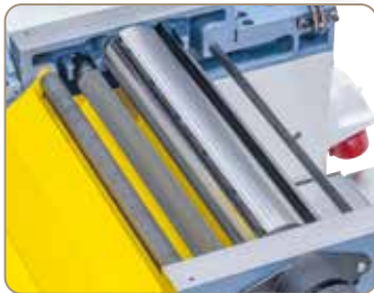
Den stabile høvleenhed med præcisionslejret 3-klinget kutter sikrer bedste høvleresultater.
