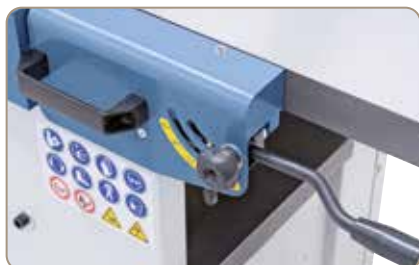
Hurtig og enkel indstilling af spåntagning op til maks. 3 mm.
