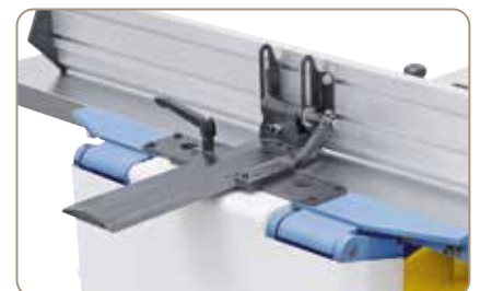
Afretteranslaget indstilles ved hjælp af en præcis prismeføring til den ønskede position.
