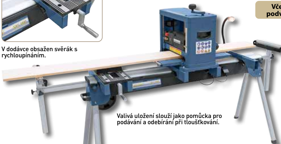
Posuvné upínací kolejnice lze rychle a snadno nastavit na šířku stroje.
