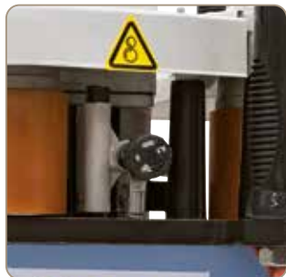
Jednoduché nastavení pro většinu používaných hran (tloušťky 0,3 / 1 / 2 / 3 mm)
