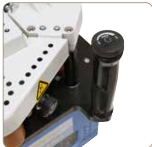
Komfortní regulace posuvu 2 - 6 m/min na rukojeti, ideální ke zpracování různých obrobků
