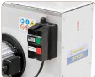
Uzamykatelný vypínač IP 54 s podpětovým spouštěčem
