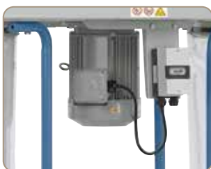
Výkonný motor zaručuje konstantní odsávací výkon i při trvalém provozu
