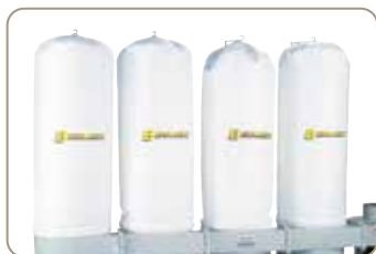
Speciálně tkané filtrační pytle snižují obsah prachu ve vzduchu
