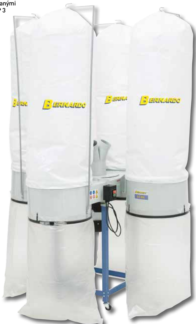
Sériově dodávaný rozdělovač poskytuje čtyři přípojky prům. 100 mm
