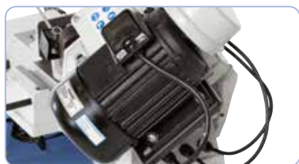
Výkonný motor z šedé litiny s krytím IP 54, na objednávku s napětím 230 V nebo 400 V
