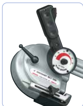
Plynule nastavitelná rychlost pilového pásu pro optimální nastavení řezných podmínek
