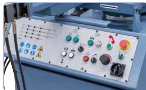
Otočný spínač k plynulému ovládní rychlosti řezu a regulační ventil pro dosedací přítlak na ergonomicky umístěném ovládacím panelu
