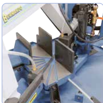
Při pokosovém řezání lze rám pily naklápět v úhlu od 90° do 60°
