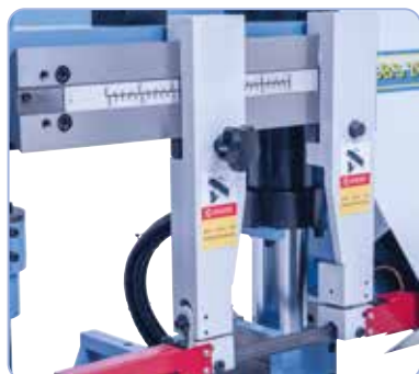
Nastavitelné vedení pilového pásu zabraňuje jeho pohybu do stran nebo naklání.
