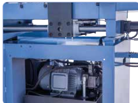
Hydraulická jednotka je pro úsporu místa umístěna v tělese stroje.
