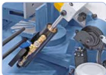
Hydraulický válec umožňuje plynulé spuštění ramene pily
