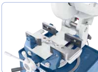
Svěrák s automatickým středěním a podélně posuvnými upínacími čelistmi
