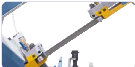
Pilový pás vedený v kuličkových ložiscích zajišťuje přesné výsledky řezu
