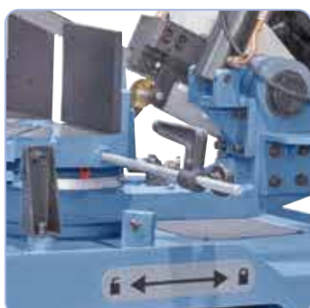
S délkovým dorazem pro zajištění hospodárné práce, ideální pro opakované řezy
