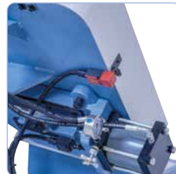
Standardní vybavení hydraulickým napínáním pilového pásu
