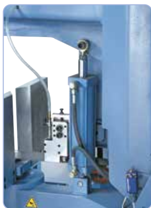
Konstantní spuštění ramene pily zajišťuje robustní hydraulický válec
