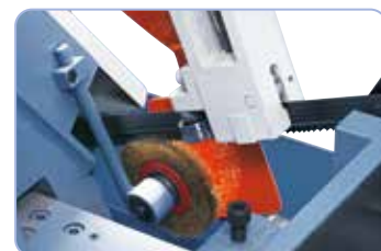
Vedení pilového pásu v kuličkových ložiscích a stírací kartáč na třísky zajišťují optimální výsledky řezu
