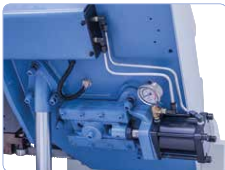
Standardní vybavení hydraulickým napínáním pilového pásu (NC Pro)
