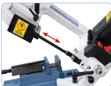
Vedení pilového pásu lze nastavit na šířku materiálu
