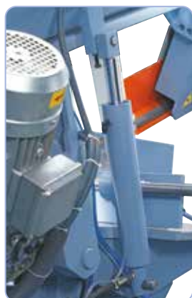
Sériově vybavená hydraulickým válcem, který umožňuje citlivé spuštění ramene pily
