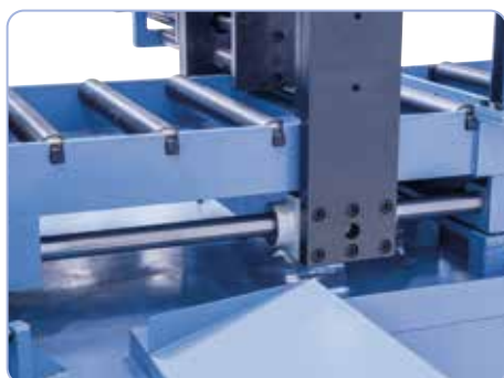
Přesné vedení a hydraulický pohon pro nejvyšší přesnost polohování obrobku.
