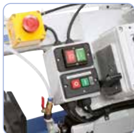
Centrální uspořádání ovládacích prvků na pilovém rameni
