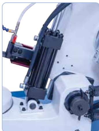
Sériově vybavená hydraulickým válcem pro plynulé spouštění ramene pily a automatickým vypnutím pomocí koncového spínače po ukončení řezání
