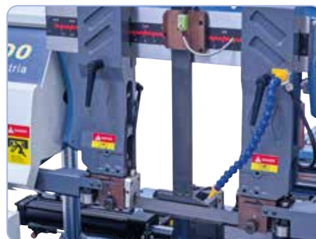
Nastavitelné vedení pilového pásu zabraňuje jeho pohybu do stran nebo naklání.
