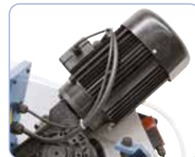
Výkonný motor z šedé litiny s krytím IP 54
