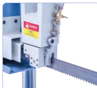
Vedení pilového pásu v kombinovaném systému válečků a čelistí s vložkami z tvrdokovu
