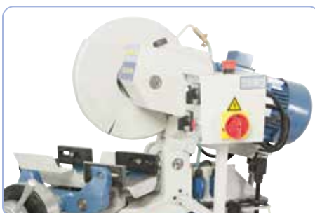
Nastavitelná hlava převodovky pro úhlové řezy do 90° vpravo a vlevo
