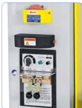
Včetně svářečky pilového pásu se zařízením na žihání pásu, nůžkami a bruskou
