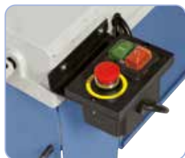
Bezpečnostní spínač s podpětovou spouští a samostatný nouzový vypínač, automatické vypínání koncovým spínačem po ukončení řezu
