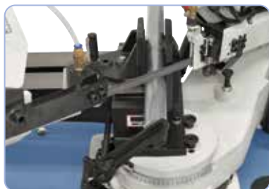
Naklápěcí rameno pily s nastavením úhlu od -45^\circ do +45^\circ pro pokosové řezání
