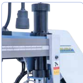
Sériově vybavená hydraulickým válcem, který umožňuje citlivě spouštění ramene pily
