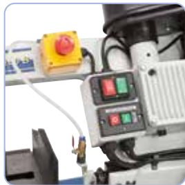
Centrální uspořádání ovládacích prvků na pilovém rameni
