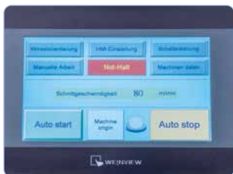
V automatickém režimu lze programovat délku posuvu, úhel řezu a počet řezů.
