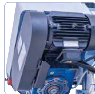
Řemenový pohon se 3 nastavitelnými řeznými rychlostmi.
