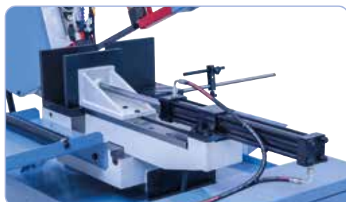
Robustní svěrák z šedé litiny s hydraulickým upnutím
