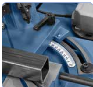
Naklápěcí rameno pily pro pokosové řezání do úhlu 60°
