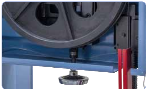
Požadované napnutí pilového pásu se provádí ručním kolem
