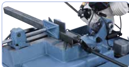
Jednoduché nastavení svěráku pomocí rychloupínací páky
