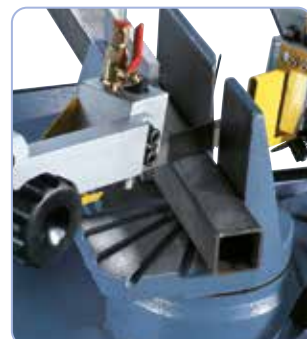
Při pokosovém řezání lze rám pily naklápět v úhlu od 90° do 60°
