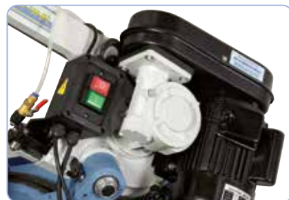
Řeznou rychlost (24 / 41 / 61 / 82 m/min) lze rychle a jednoduše změnit přesunutím klínového řemenu
