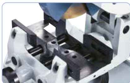
Masivní svěrák s automatickým středěním a podélně posuvnými upínacími čelistmi
