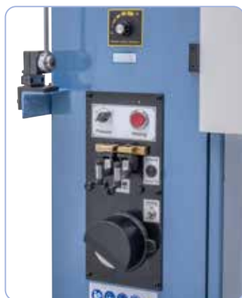
Součástí dodávky je svářečka pilového pásu, zařízení na žihání pásu, nůžky a brousek.
