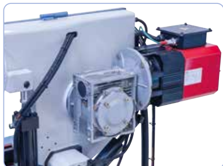
Plynulá regulace řezné rychlosti a vysoký točivý moment díky výkonnému servomotoru
