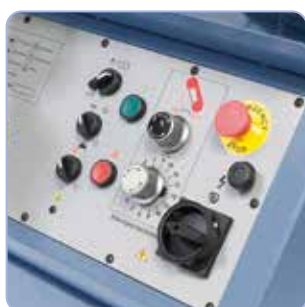
Komfortní nastavení rychlosti spouštění ramene pily pomocí regulačního ventilu
