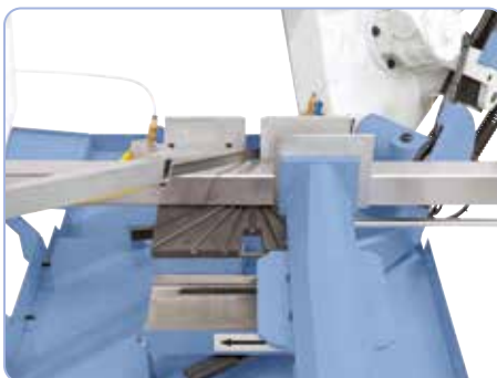
Vedení pilového pásu v kombinovaném systému válečků a čelistí s vložkami z tvrdokovu
