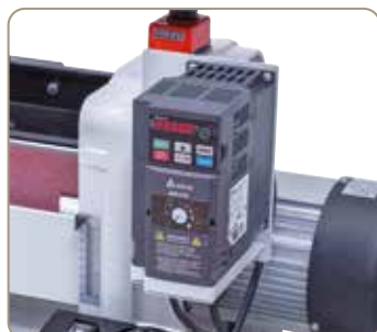
Kvalitní frekvenční měnič umožňuje plynulé nastavení otáček vřetene
