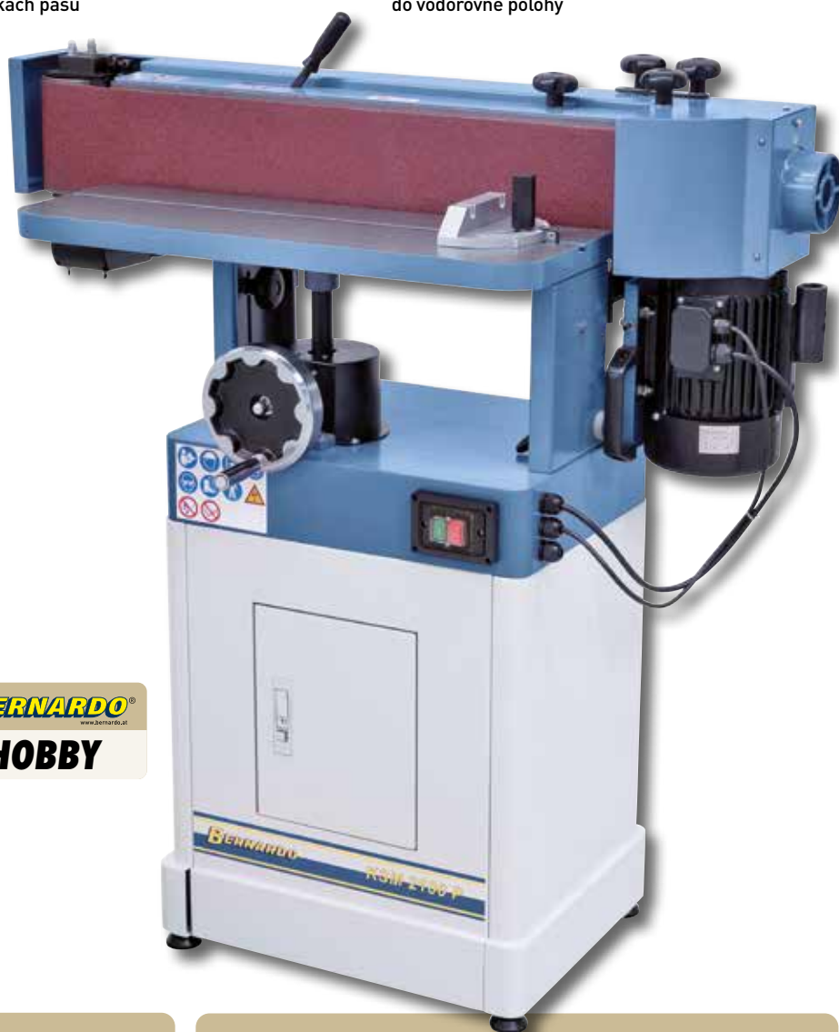
Odpružené napínání pásu, které automaticky vyrovnává rozdíly v délkách pásu
