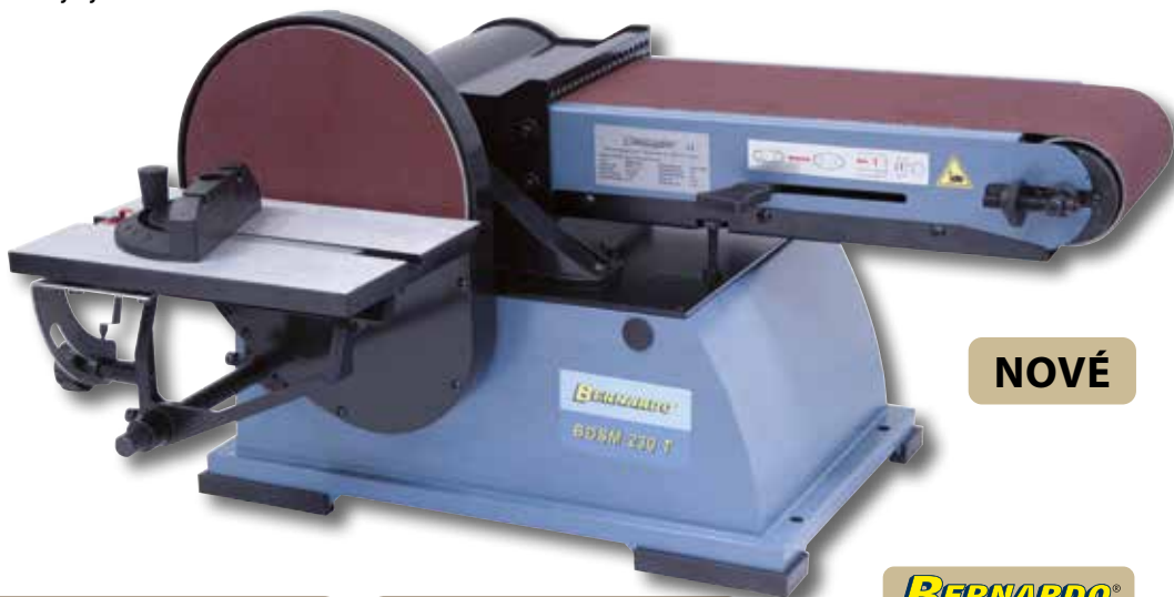
Stůl pro rovinné broušení lze použít jak ve vodorovné, tak ve svislé poloze.
