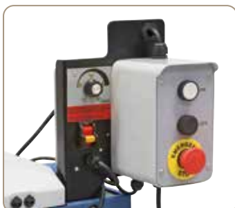
Plynule nastavitelná rychlost posuvu
