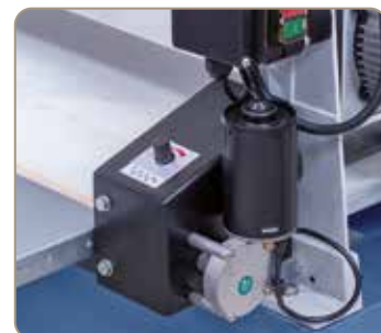
Plynule nastavitelná rychlost posuvu
