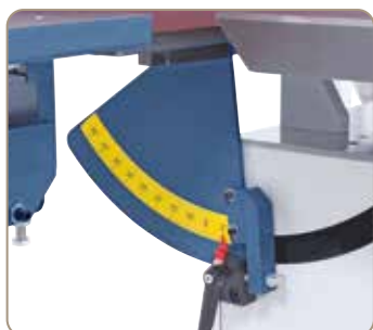
Naklápěcí brousící agregát (90° až 45°), s nastavitelným koncovým dorazem při úhlu 90°
