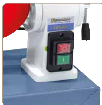
Vypínač s podpětovým spouštěčem a krytím IP 54.
