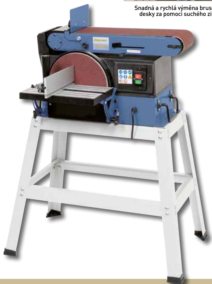
Stůl pro rovinné broušení lze použít jak ve vodorovné, tak ve svislé poloze
