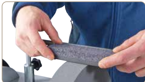
05-2050 Orovňovací a oživovací kámen slouží k přípravě brusného kotouče (jemný / hrubý)
