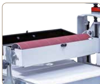
Sklápěcí kryt odsávání umožňuje výměnu brusného pásu
