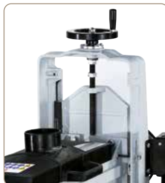
Stabilní vodicí systém, nastavení výšky pomocí ručního kola
