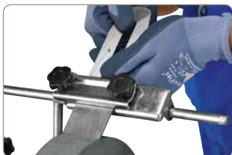
Univerzální přípravek UNI-100, vhodný na nejrůznější nástroje s přímým ostřím (součástí dodávky)
