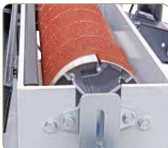
Rychloupínací systém k upevnění brusného pásu
