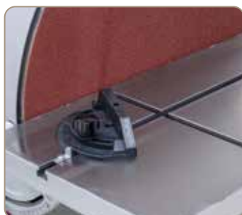
Včetně úhlového dorazu pro přesné broušení pod úhlem
