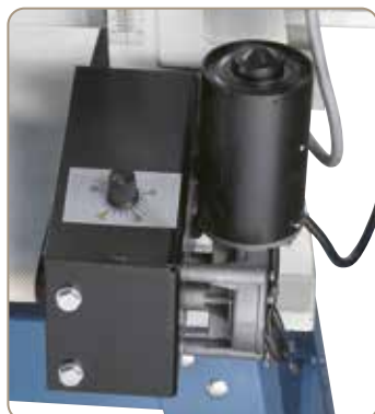
Plynule nastavitelná rychlost posuvu
