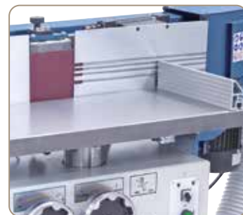
Drážkované podávací pravítko k broušení přesahů dýhy
