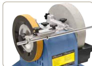
Včetně koženého obtahovacího kotouče k odstranění otřepu po broušení
