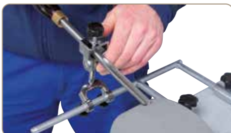
05-2052 Přípravek na soustružnická dláta: Max. průměr nástroje 20 mm
