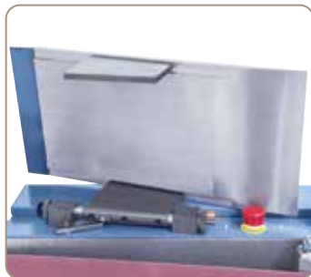
Doraz broušení s jemným nastavováním a automatickou aretací
