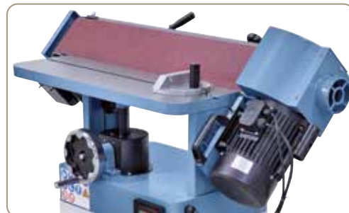
Plynule naklápěcí brousící agregát ze vodorovné polohy
