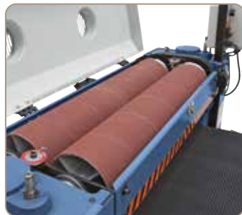
2 válce s brusnými pásy pro hrubé i přesné broušení v jednom procesu broušení.
