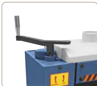
Pracovní stůl se ručním kolečkem a pomocí stupnice přizpůsobuje tloušťce obrobku
