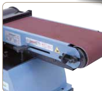
Velká plocha pro rovinné broušení, nastavitelná opěrka obrobku.
