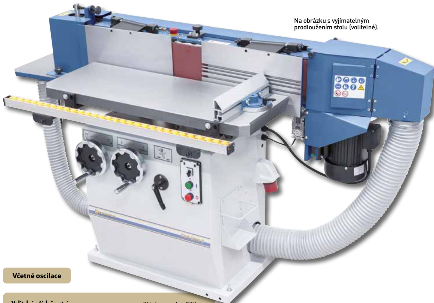
Rychlé a jednoduché otevření krytu brusného pásu pro broušení masivu (velké kusy dřeva)
