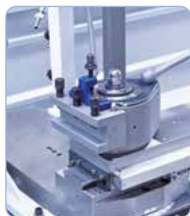
Pro hospodárnou práci je stroj sériově vybaven rychloupínacím nožovým držákem.
