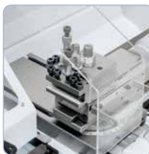
Snadný chod nožového suportu a čtyřnožového držáku pomocí ruční kola s nastavitelnou jemnou stupnicí
