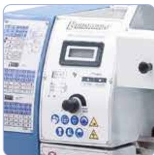
Plynulá regulace otáček vřetena s digitálním ukazatelem.
