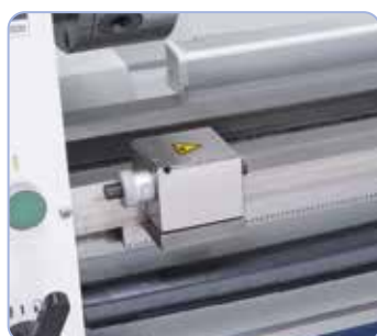
Mikrometrický doraz a kluzná spojka v základní výbavě
