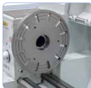
K upnutí speciálních obrobků lze dokoupit ličnicovou desku pr. 250 mm
