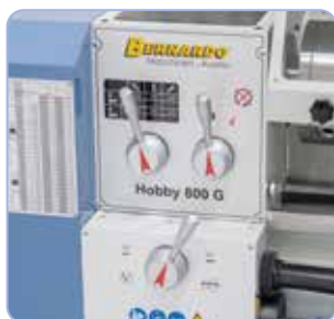
Rychlou změnu otáček vřetena lze provádět řadicími pákami převodové skříně
