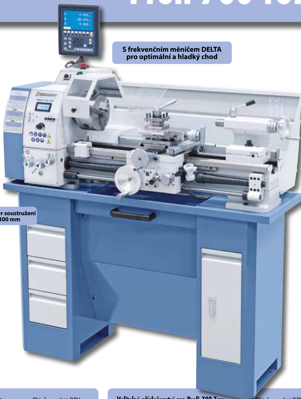
Pro práce s dlouhým materiálem je soustruh vybaven průchodem vřetena s průměrem do 38 mm (700 Top)
