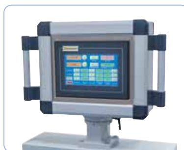
Odečítání digitálních zobrazení a všech nastavení (rychlost, rychlost posuvu, stoupání závitů atd.) prostřednictvím dotykového displeje.
