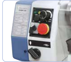
Jednoduchá obsluha, všechny ovládací prvky umístěné na vřetenové hlavě
