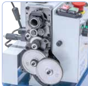
Výměnná kola v kovovém provedení pro řezání metrických závitů v základní výbavě
