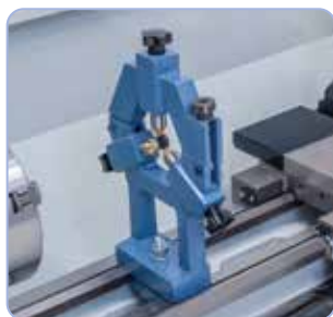
Pevná luneta s bronzovým vedením pro upínání delších obrobků
