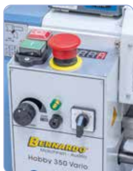
Plynulá regulace otáček vřetena s digitálním ukazatelem
