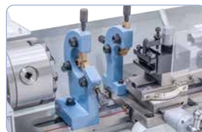
Lunety pro upínání a obrábění delších obrobků
