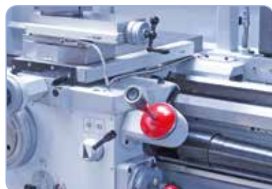
Sériově vybavených rychloposuvem pro snížení vedlejších výrobních časů
