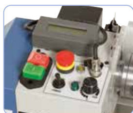
K přesnému nastavení požadovaných otáček lze stroj vybavit digitálním ukazatelem otáček
