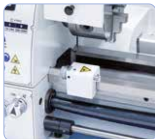
Stroj 700 Top je nově dodáván s kluznou spojkou a délkovým mikrometrickým dorazem
