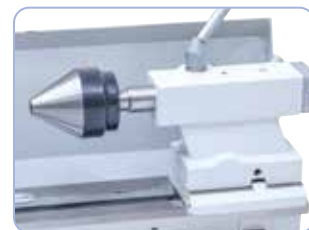
Středící hrot pr. 60 mm, ideální k upínání trubek a dutých těles (na objednávku)
