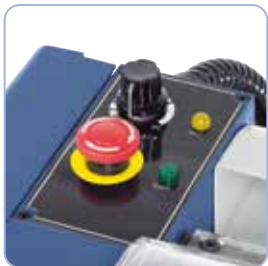
Plynulá regulace otáček hlavního vřetena pomocí potenciometru
