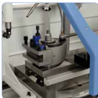
Rychloupínací nožový držák umožňuje snížení vedlejších výrobních časů a zaručuje vysokou opakovanou přesnost obrábění
