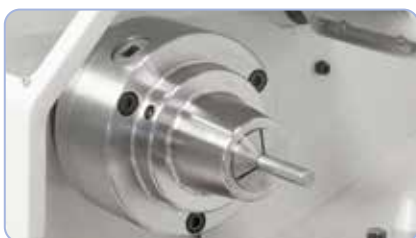
Na objednávku: kleštinový upínač 5C, rozsah upnutí 3 - 26 mm
