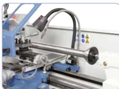
Středící hrot pr. 100 mm, ideální k upínání trubek a dutých těles (na objednávku)
