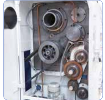
Tvrzené hlavní vřeteno se 130 mm vrtem vřetena, uložené na kuželíkových ložiscích a radiálních válečkových ložiscích.
