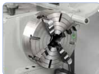
4čelistové nesoustředné sklíčidlo pr.320 mm k upnutí nesoustředných obrobků (na objednávku).
