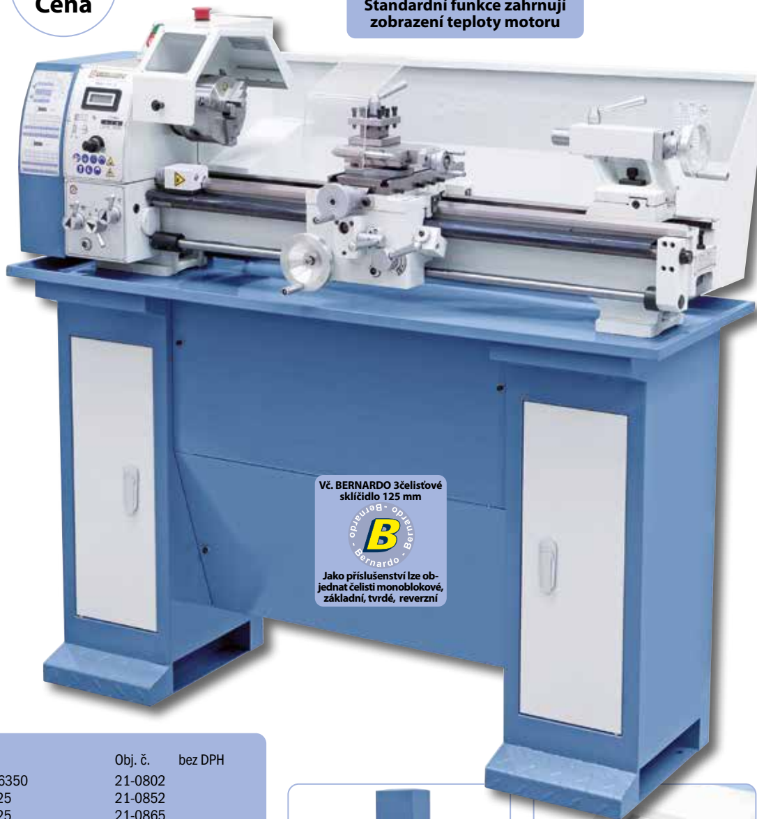
Uložení kaleného vřetena v přesných kuželíkových ložiscích zajišťuje velmi nízkou házivost ( \leq 0,009 mm)
