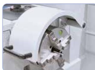
Centricky upínané 4čelistové sklíčidlo 160 mm, optimální pro čtyřhranné obrobky (na objednávku)
