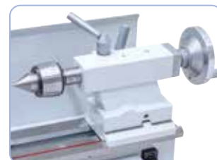
Koník s upínacím kuželem MK 2 lze nastavit pro soustružení kuželových tvarů
