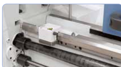
Mikrometrický doraz a kluzná spojka v základní výbavě
