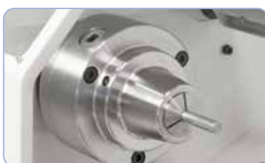
Na objednávku: kleštinový upínač 5C, rozsah upnutí 3 - 26 mm
