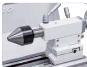
Středící hrot pr. 60 mm, ideální k upínání trubek a dutých těles (na objednávku)
