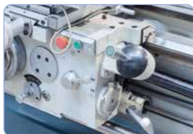
Sériově vybavený rychloposuvem pro snížení vedlejších výrobních časů
