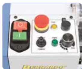
Otáčky vřetena lze plynulá regulace regulovat, otáčky vpravo-levě v základní výbavě
