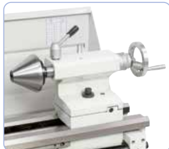
Koník s pákovou aretací, přestavitelný pro soustružení kuželů, lze na objednávku dodat se středícím hrotem
