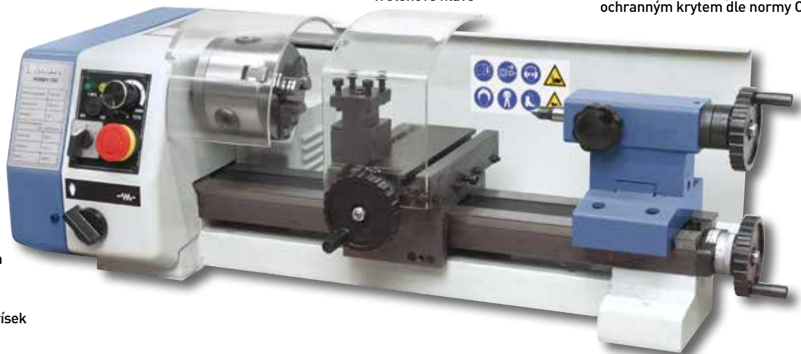
Jednoduchá obsluha, všechny ovládací prvky umístěné na vřetenové hlavě
