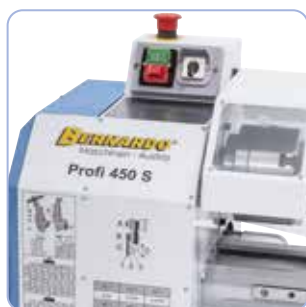
Ovládací prvky s tabulkou posuvů jsou přehledně umístěné na vřetenové hlavě
