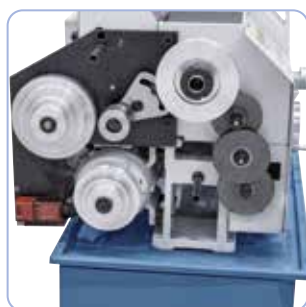
Výměnná kola na řezání závitů jsou součástí základní výbavě
