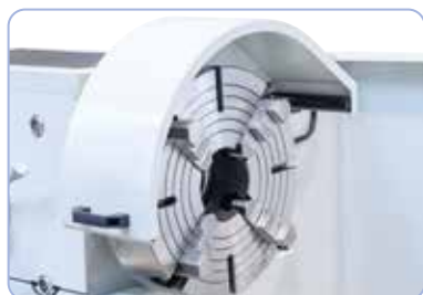
4čelistové nesoustředné sklíčidlo pr.400 mm k upnutí nesoustředných obrobků (na objednávku).
