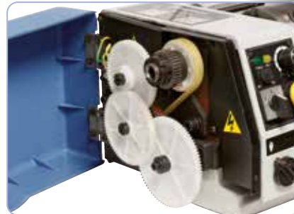
S vyměnitelnými koly na řezání závitů, stoupání 0,5 - 1,25 mm (na objednávku)
