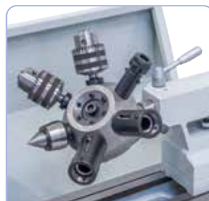
Pro urychlení práce lze ke stroji doobjednat revolverovou upínací hlavu se třemi polohami (na objednávku)
