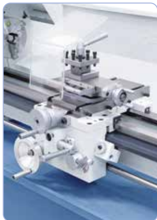
Délkový a příčný pohyb suportu, popřípadě horního suportu, zajišťuje 6 přímo volitelných posuvů
