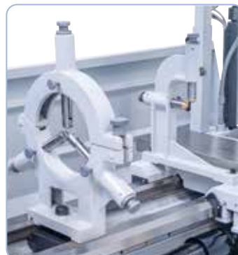
Sériově dodávaná pevná, popřípadě pohyblivá luneta ke stabilizaci dlouhých obrobků
