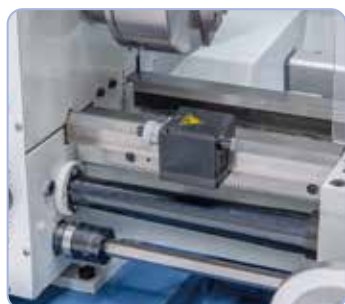
Mikrometrický doraz a kluzná spojka v základní výbavě
