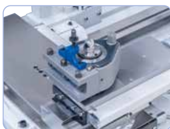
Rychloupínací nožový držák umožňuje snížení vedlejších výrobních časů a zaručuje vysokou opakovanou přesnost obrábění.
