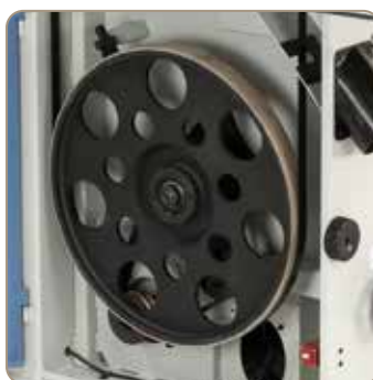
Dynamicky vyvážená oběžná kola z šedé litiny zajišťují klidný chod (HBS 500 N).
