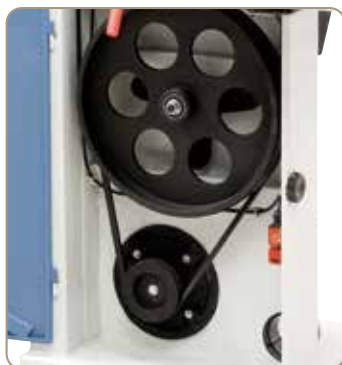
Robustní klínová řemenice a vysoce kvalitní klínový řemen zajišťují optimální přenos výkonu z motoru
