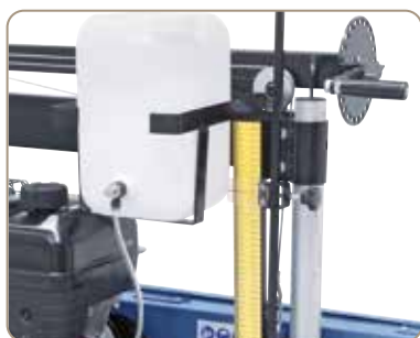
Nastavení výšky pilového agregátu se provádí ruční klikou a lze ji odečítat na stupnici
