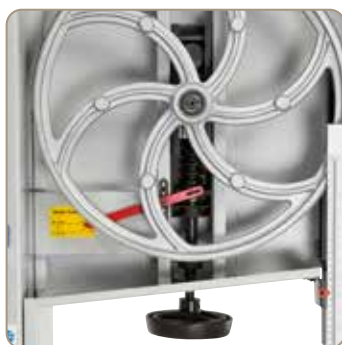
Nastavení napnutí pilového pásu se provádí ručním kolem a zobrazuje se v diagramu na horním oběžném kole.
