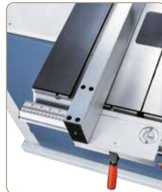
Snadno nastavitelný hliníkový doraz s rychloupínáním, odečítáním milimetrové stupnice pomocí lupy
