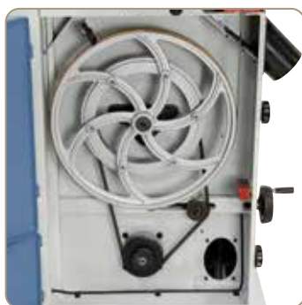
Požadovaná řezná rychlost se nastavuje pomocí klínového řemenu na spodním oběžném kole (HBS 400 N / HBS 460 N).
