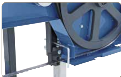
Kombinované vedení s válečky a tvrdokovem zamezuje rychlému opotřebení pilového pásu
