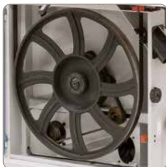
Hnací kolo se speciálním pryžovým potahem zajišťuje klidný chod a zvyšuje životnost pilového pásu
