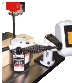
Na objednávku: CO-MATIC podavač pro přesné vedení řezy
