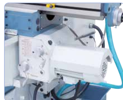
9stupňový posuv pro osy x, y v základní výbavě
