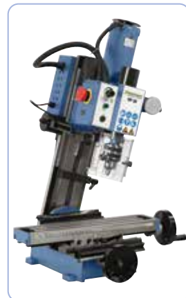
KF 20 se sériově dodává s naklápěcí frézovací hlavou zvyšující rozsah použití
