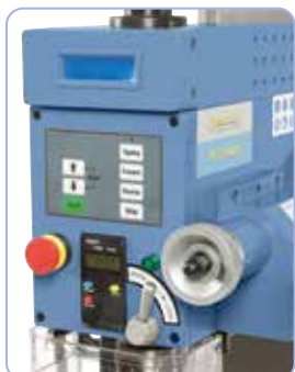
Lehce čitelné digitální zobrazení, příjemné ovládání pomocí fóliové klávesnice
