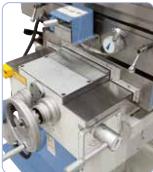
Masivní provedení vodicích ploch v osách y, z zajišťuje zvýšenou stabilitu
