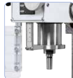
Silně dimenzované vřeteno s kuželíkovými ložisky zajišťuje velmi nízkou házivost
