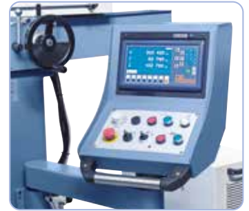
Přehledně uspořádané ovládací prvky na sklopném panelu, sériově dodávané se 3osým digitálním odměřováním s LCD displejem.
