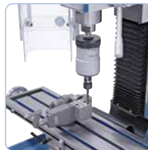
Pro řezání závitů lze objednat závitorezную hlavu o rozsahu závitů M 5 - M 12
