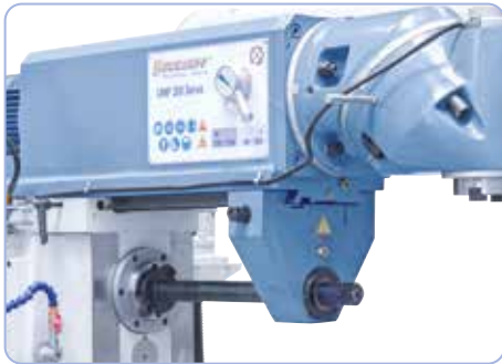
Opěrné ložisko a dlouhý frézovací trn k horizontálnímu frézování v základní výbavě
