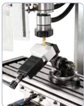
Frézování s trojosým otočným svěrákem PGS 50
