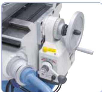
Polohovací motor k nastavení výšky stolu v ose z
