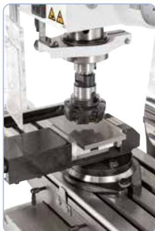
Frézování rovinou frézou (Obj.č. 42-1085)
