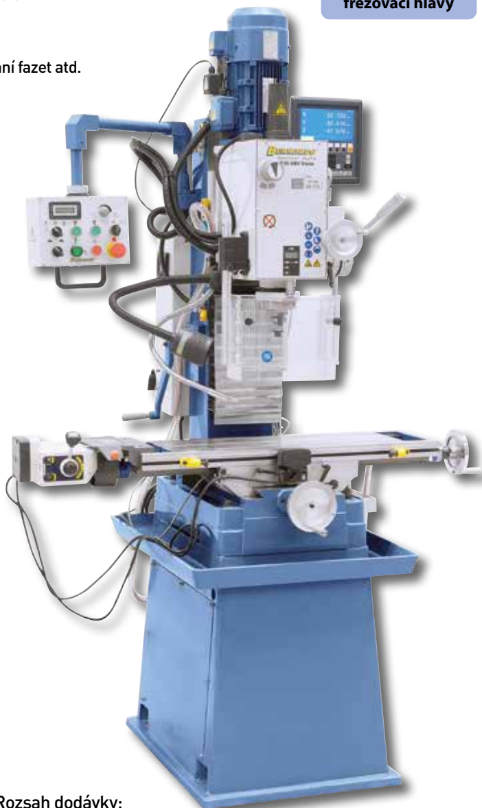
Masivní provedení křížového stolu s T-drážkami a oběžným žlábkem na chladicí kapalinu. Zobrazení se sériovým posuvem frézovacího stolu AL 450 D
