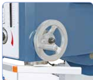
Nastavení výsuvu pinoly do 100 mm pomocí ručního kola
