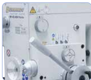
Posuv pinoly lze volit v hodnotách 0,10 / 0,18 nebo 0,26 mm/ot
