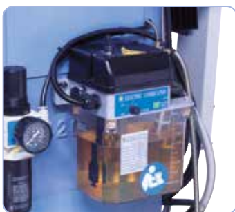
Elektrické centrální mazání pro všechny vodící lišty a vřetena
