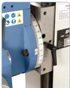
Bezúdržbové rybinové vedení s nastavitelnými klínovými zarážkami
