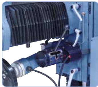
Ovladač posuvu (na obrázku pro osu x a z), vlastní nastavení rychlosti se provádí potenciometrem na kontrolním panelu.
