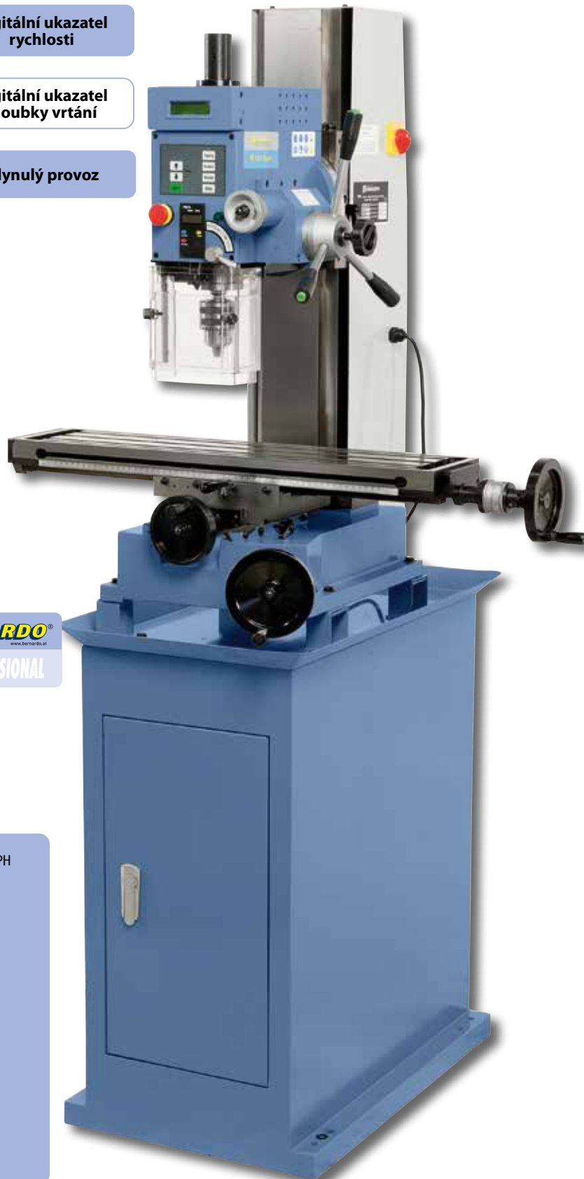
Otočný stůl umožňuje další využití stroje (stůl na objednávku)
