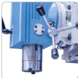
Masivní pinola (Ø 90 mm) zajišťuje vysokou stabilitu
