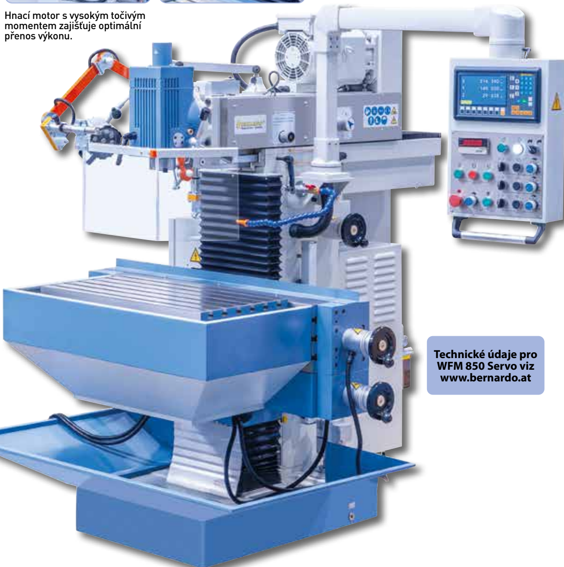
Polohovatelné ochranné zařízení, použitelné jak pro vertikální, tak i pro horizontální frézování.
