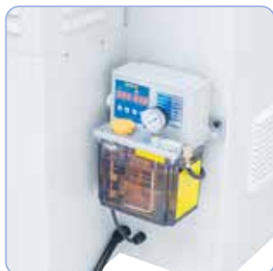
V dodávce elektrické centrální mazání
