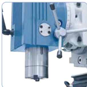
Masivní pinola (Ø 90 mm) zajišťuje vysokou stabilitu
