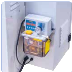
V dodávce elektrické centrální mazání
