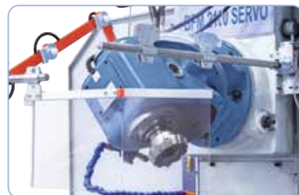
Přestavením 90° a 45° roviny lze univerzální naklápací hlavu nastavit do všech poloh s libovolným úhlem
