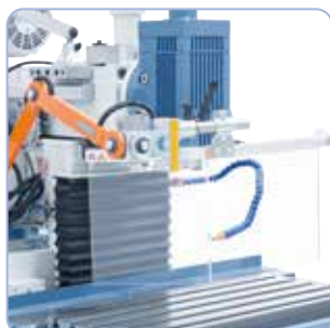
Polohovatelné ochranné zařízení, použitelné jak pro vertikální, tak i pro horizontální frézování.
