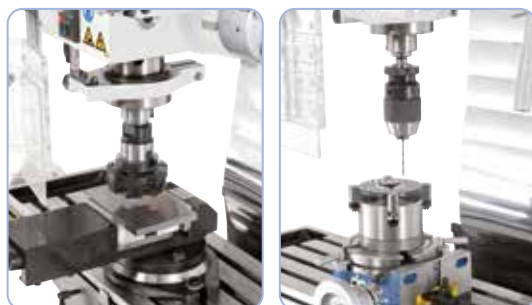
Frézování rovinou frézou Souřadnicové vrtání (Obj.č. 42-1085)
