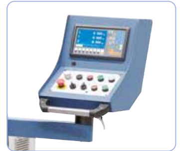
Přehledně uspořádané ovládací prvky na sklopném panelu, sériově dodávané se 3osým digitálním odměřováním s LCD displejem.
