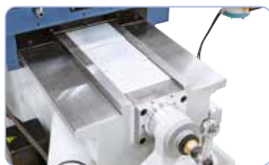
Masivní hranolové vedení v ose y
