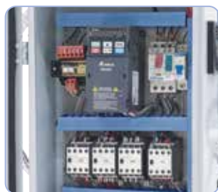
Frekvenční měnič v základní výbavě
