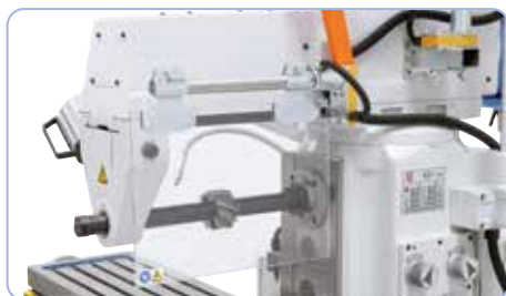
Opěrné ložisko a dlouhý frézovací trn k horizontálnímu frézování v základní výbavě
