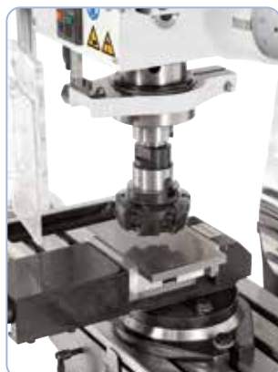
Frézování rovinnou frézou (Obj.č. 42-1085)
