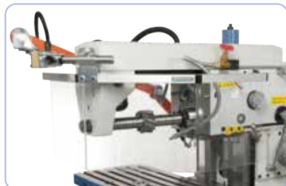
Horizontální frézování s opěrným ložiskem
