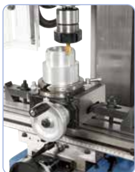
Otočný stůl umožňuje další využití stroje (stůl na objednávku)
