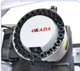
Sériově je vybaven 24-dílným výměníkem nástrojů.
