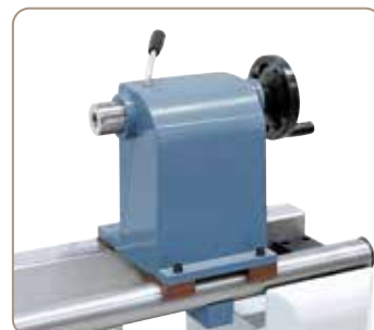
Upínací pákou lze koník upevnit rychle a snadno na lože stroje
