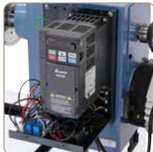
Kvalitní frekvenční měnič umožňuje plynulé nastavení otáček vřetene.
