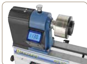
Jednoduché odečítání otáček na LED displeji
