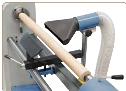
Odsávání, které lze dodat na objednávku, zajišťuje při soustružení čisté pracoviště
