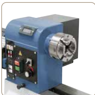
Šada sklíčidel Premium M 115, Čelisti s rybinovým vedením typ A
