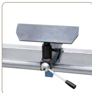
Jednoduché upnutí opěrky ruky pomocí rychloupínací páky
