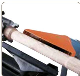
Odsávání, které lze dodat na objednávku, zajišťuje při soustružení čisté pracoviště
