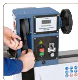
Jednoduchá změna převodového stupně přeložením klínového řemenu.
