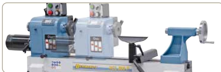
Celý vřeteník lze libovolně posunout do požadované pozice a lze kdekoli na loži ukotvit
