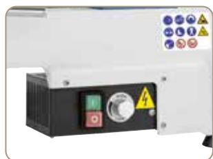
Plynulá regulace umožňuje optimální přizpůsobení otáček
