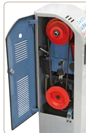
Použití vyvážených řemenic a kvalitních řemenů garantuje klidný a tichý chod
