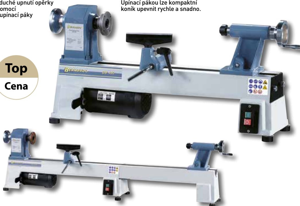
Obrázek s volitelným prodloužením lože na 980 mm
