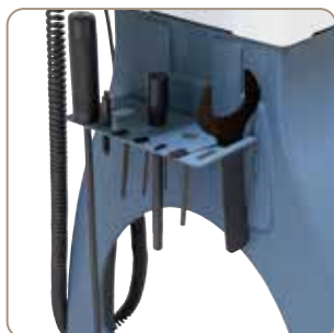
Sériový držák nářadí poskytuje optimální odkládací prostor na obslužné nářadí.
