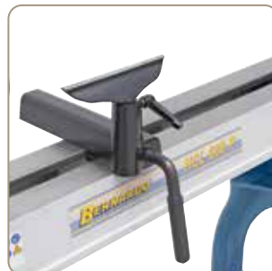
Jednoduché upnutí opěrky ruky pomocí rychloupínací páky
