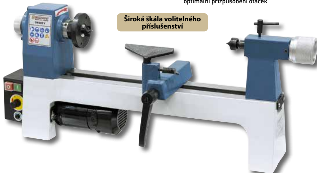
Sérově vybaveno ruční podpěrou 110 mm, příp. 175 mm.
