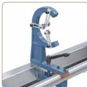
Součástí dodávky je pevná luneta na průměr hřídele do max. 90 mm
