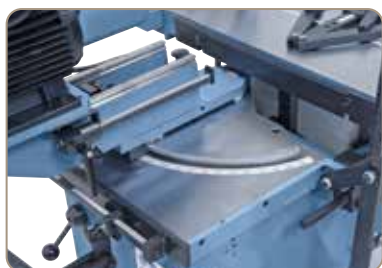
Vrtací agregát umožňuje naklání 60° vpravo i vlevo
