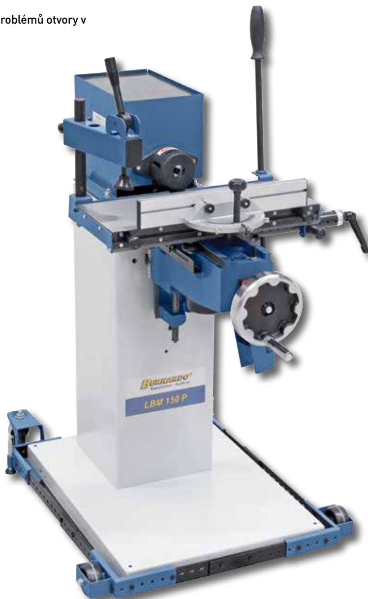
Nouzový vypínač a přepínač směru otáček najdete na tělese stroje.
