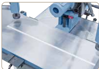
Zapuštěná stupnice ve stole s nulovým bodem uprostřed
