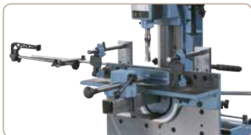
Stabilní pracovní stůl, naklápěcí v úhlu 45° vpravo a vlevo
