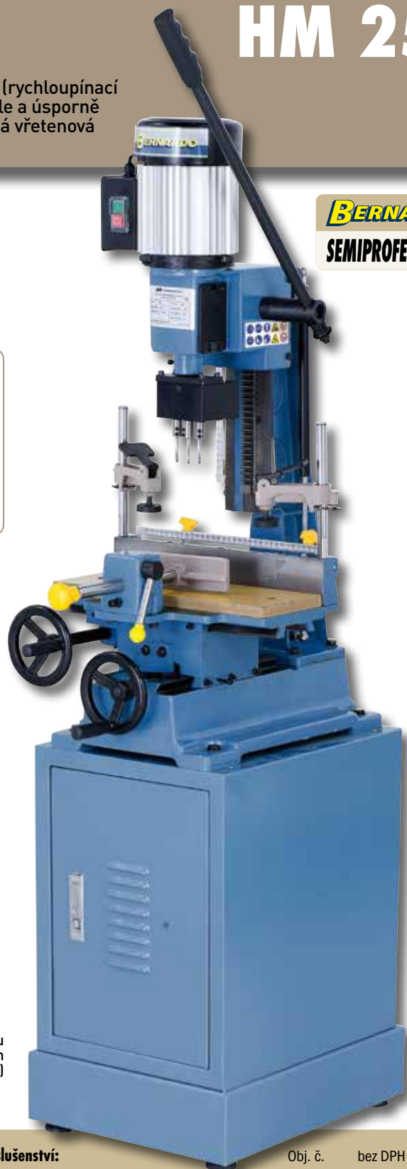
Nastavitelná vřetenová hlava o 180°, ideální na dlabání dveřních zámků a kování
