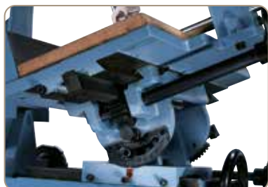
Pracovní stůl, naklápěcí dopředu a dozadu, umožňuje rozšířené využití
