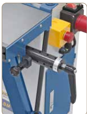
Sériově dodávané s kolíkovacím zařízením, rastr 16 / 20 / 22 / 25 mm
