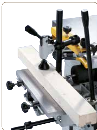
Přídavná vrtací dlabáčka je ideální k dlabání, kolíkování, šikmému drážkování, ...
