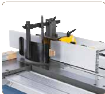
Masivní ochranný kryt frézy lze použít na nástroje do průměru 140 mm
