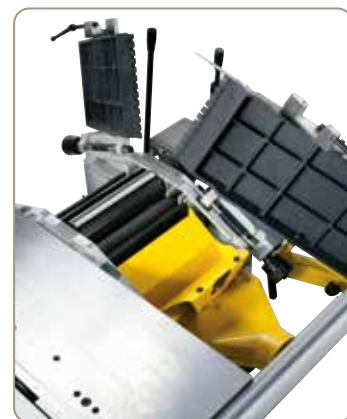
Odklápěcí srovnávací stoly umožňují optimální a bezpečnou práci i při protahování krátkých obrobků
