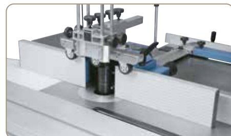
Masivní ochranný kryt frézy s jemně nastavitelnými dorazovými lištami
