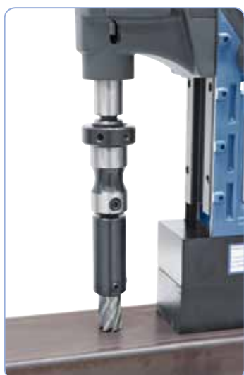
Jádrové vrtáky s prodlužovacím adaptérem
