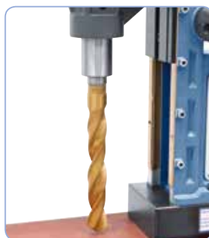
Dodávána sériově s upínacím kuželem MK 3 pro upínání nejrůznějších nástrojů
