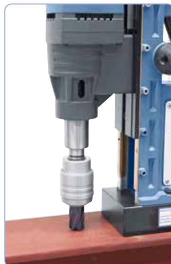
Jádrový vrták HSSC05, povrchová úprava nACO
