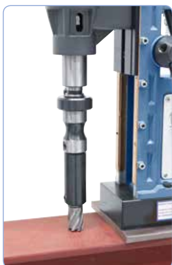
Jádrové vrtáky s prodlužovacím adaptérem
