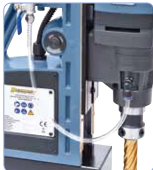
Přesné nastavení rychlosti řezu pomocí potenciometru.
