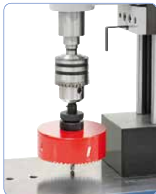
Dodávána sériově s upínacím kuželem MK 3 pro upínání nejrůznějších nástrojů
