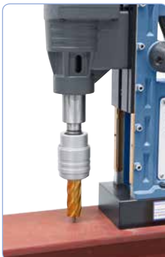
Jádrový vrták HSS, povrchová úprava TiN
