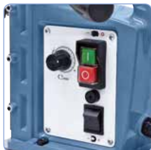
Přesné nastavení rychlosti řezu pomocí potenciometru.
