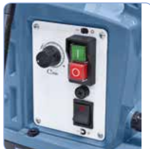
Přesné nastavení rychlosti řezu pomocí potenciometru.
