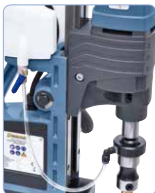
Automatické vnitřní mazání, chladicí kapalina je vedena přímo na špičku jádrového vrtáku
