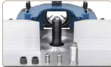
Výměnné vřeteno umožňuje při sériové výrobě obrovskou úsporu času.
