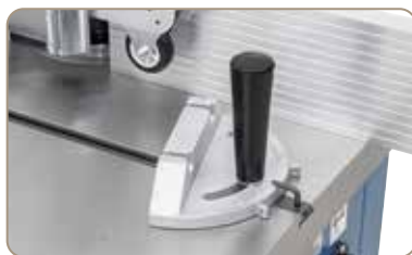
Sérově dodávaný úhlový doraz lze natáčet v úhlu od -60° do +60°.
