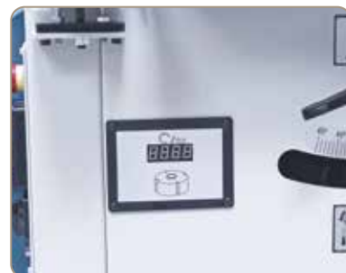
Elektronický displej zobrazuje nastavené otáčky frézy
