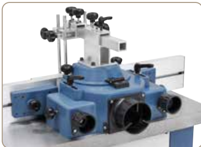
Masivní doraz frézy lze použít pro nástroje do 200 mm. Oboustranné dorazové lišty jsou sériově vybavené jemným nastavením.
