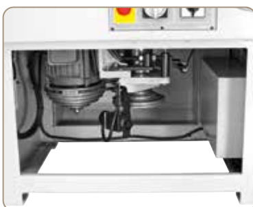
Velký otvor na přední části stroje umožňuje jednoduchou změnu řemene při volbě rychlosti
