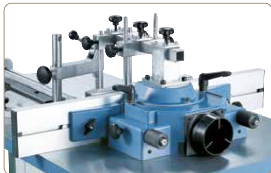
Ochranný kryt frézy je vybaven jemným nastavením. Odvod třísek je proveden pomocí integrované přípojky odsávání.
