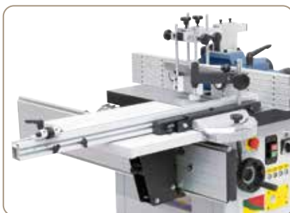
Pojezdový vozík (na přání) rozšiřuje oblast možností pro využití stroje
