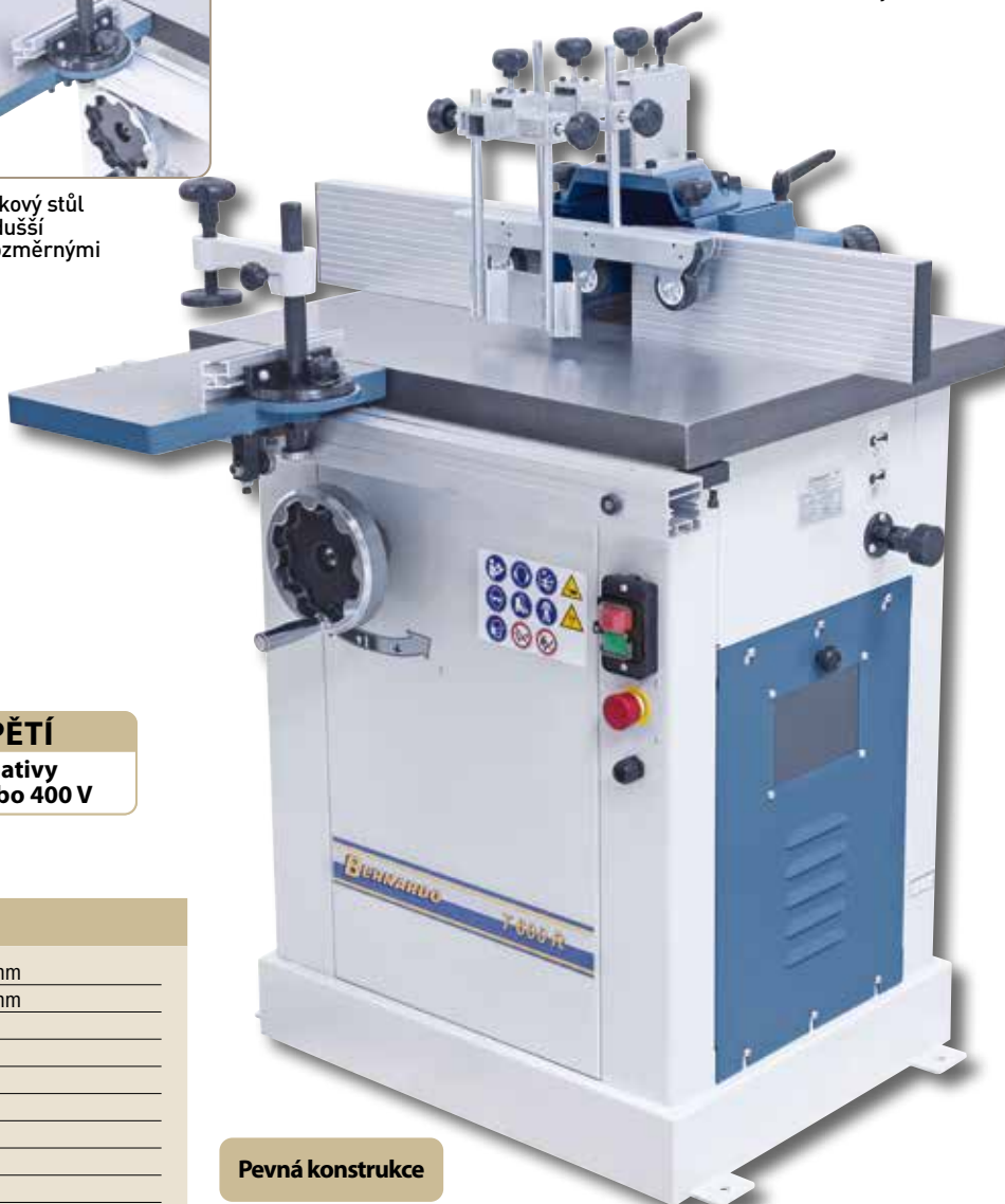
Ochranný kryt frézy je vybavený eloxovanými hliníkovými dorazovými lištami
