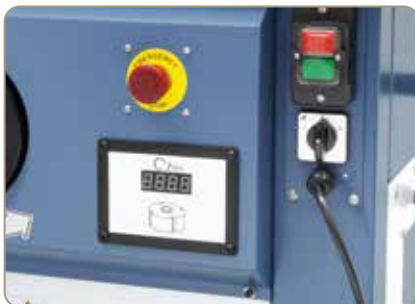
Elektronický displej zobrazuje nastavené otáčky frézy.
