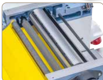
Stabilní hoblovací jednotka s přesně uloženým 3nožovým hřídelem zaručuje nejlepší výsledky hoblování
