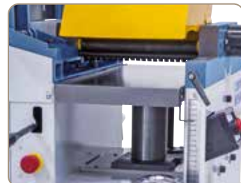
Stabilní tloušťkovací stůl s bočním sloupovým vedením a podpěrou zajišťuje přesné hoblování prken, lišt, fošen, ...
