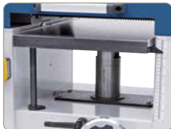
Tloušťkovací stůl, odolný proti zkroucení, je vedený středovým sloupem a zajištěn podpěrami
