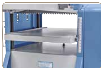
4násobně vedený protahovací stůl, nastavení výšky pomocí číselné stupnice
