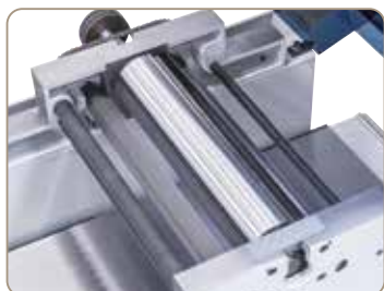
Přesně uložený 4nožový hřídel a podélně rýhovaný podávací válec pro zajištění nejlepších výsledků hoblování
