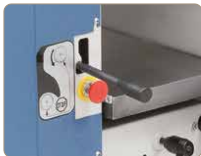
Posuv lze při srovnávání vypnout
