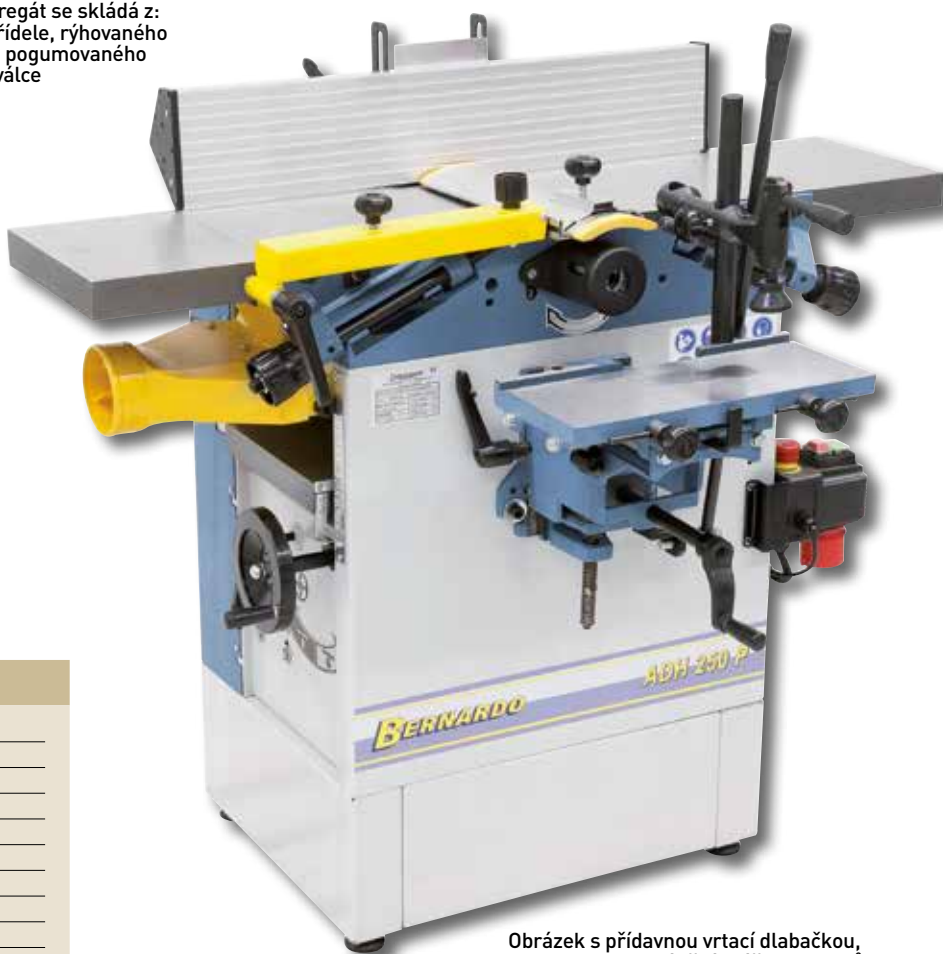
Zářezy v hraně stolu minimalizují zatížení hlukem
