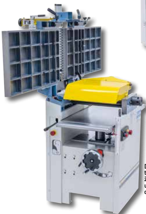
Stabilní hoblovací jednotka s přesně uloženým 3nožovým hřídelem zaručuje nejlepší výsledky hoblování
