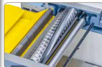
Stabilní hoblovací jednotka s přesně uloženým spirálovým nožovým hřídelem zaručuje nejlepší výsledky hoblování.
