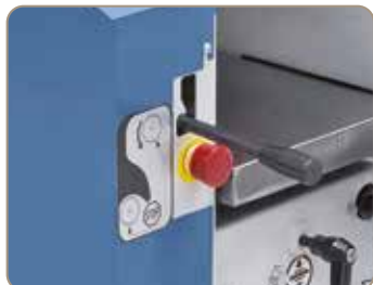
Posuv lze při srovnávání vypnout
