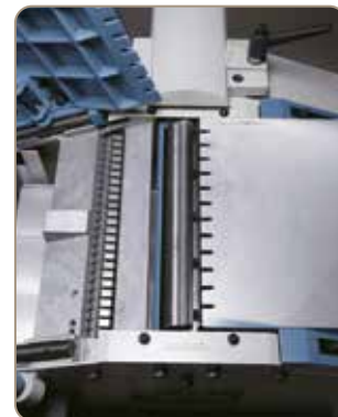
Přesně uložený nožový hřídel a rýhovaný podávací válec pro zajištění nejlepších výsledků hoblování
