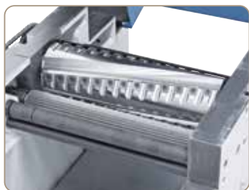
Přesně uložený spirálový nožový hřídel a podélně rýhovaný podávací válec zajišťují nejlepší výsledky hoblování.
