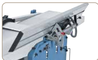
Hliníkové srovnávací pravítka, sklopné v úhlu od 90° do 45°
