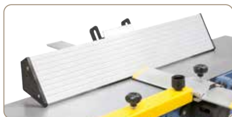
Masivní a snadno nastavitelné vodící pravítko s prizmatickým vedením, naklápěcí do 45°
