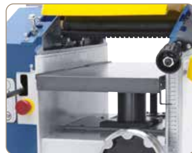
Srovnávací stůl z šedé litiny se středovým centrálním sloupem a podpěrou, k hoblování obrobků do výšky 180 mm
