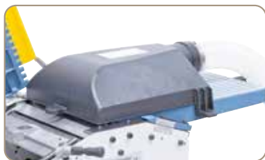
Kombinovaný kryt na odvádění třísek použitelný při srovnávání a tloušťkování
