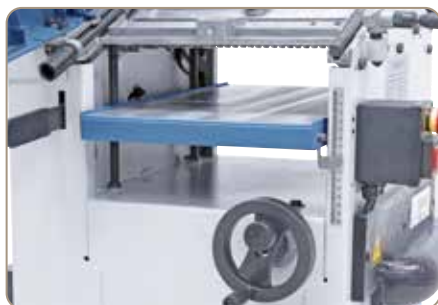
Tloušťkovací stůl s přesným 4násobným vedením, nastavenou výšku úběru lze odečítat na stupnici
