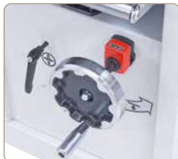
Nastavení výšky tloušťkování se provádí pomocí digitálního displeje s přesností na 1/10 mm
